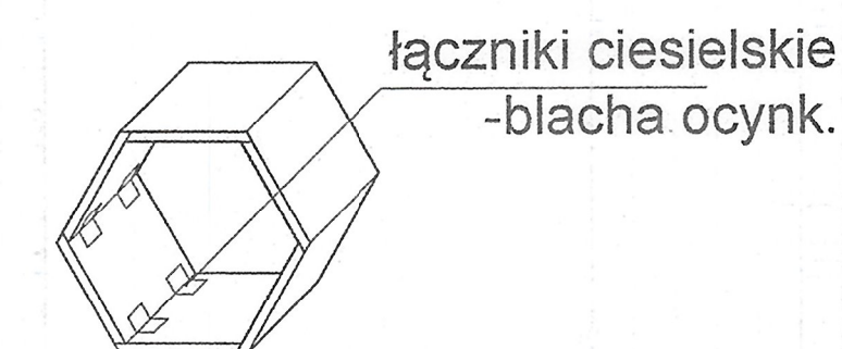
DETAIL MOCOWANIA ŚCIANEK KASETONÓW
